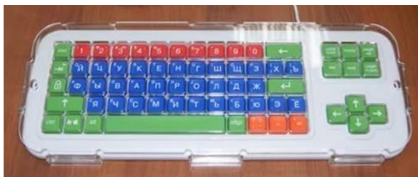
Рис. 2 Клавиатура с увеличенным размером клавиш и специальной накладкой для ограничения нажатия двух соседних клавиш
