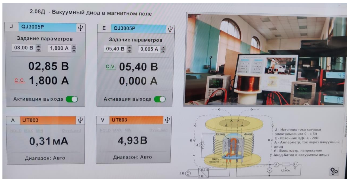
Рис. 2. Окно рабочей программы управления установкой «Вакуумный диод в магнитном поле» в режиме удаленного доступа
