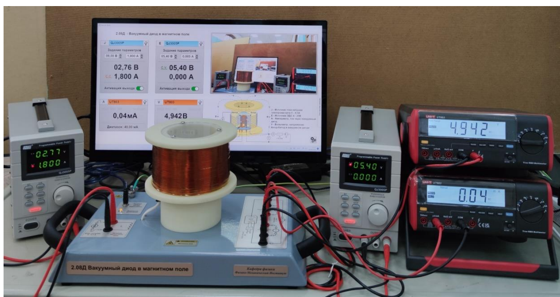
Рис. 1. Общий вид лабораторной установки «Вакуумный диод в магнитном поле»
